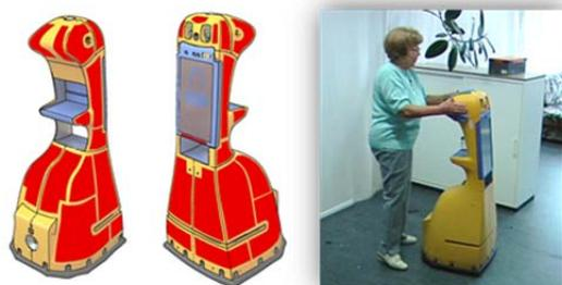
**Abbildung 3:** Integration kapazitiver Sensoren zur berührungsbasierten Steuerung des Roboters.
