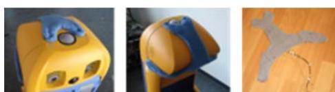
**Abbildung 4:** Integration eines Streichelsensors zur Umsetzung eines haptischen Feedbacks.
